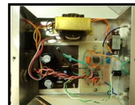
Foto do circuito evidenciando o amplificador e a fonte simétrica
