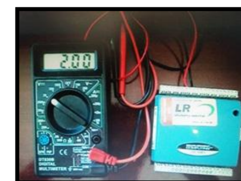
Foto do conversor fornecendo 2.00 V indicados pelo usuário.
