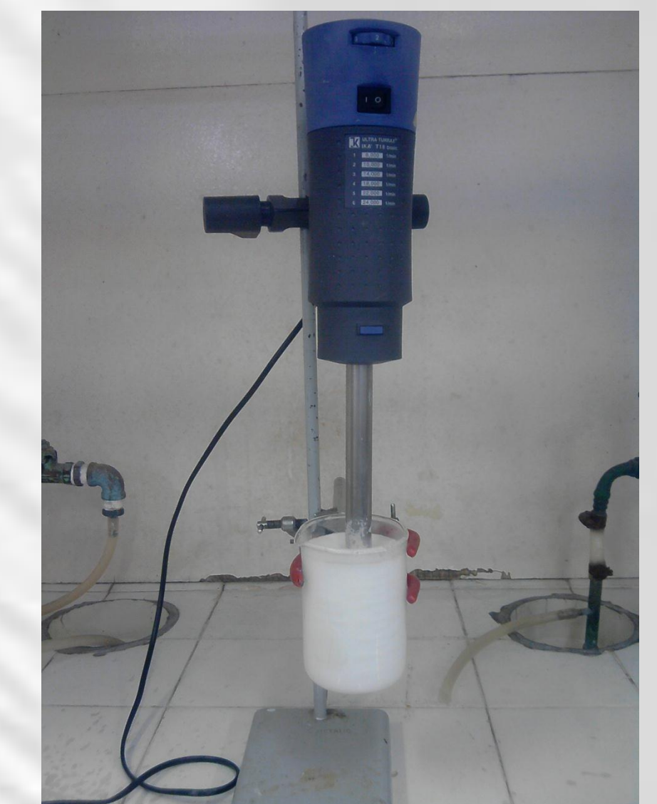
Figura 3: Manipulação do Leave-In utilizando um Ultra Turrax®
