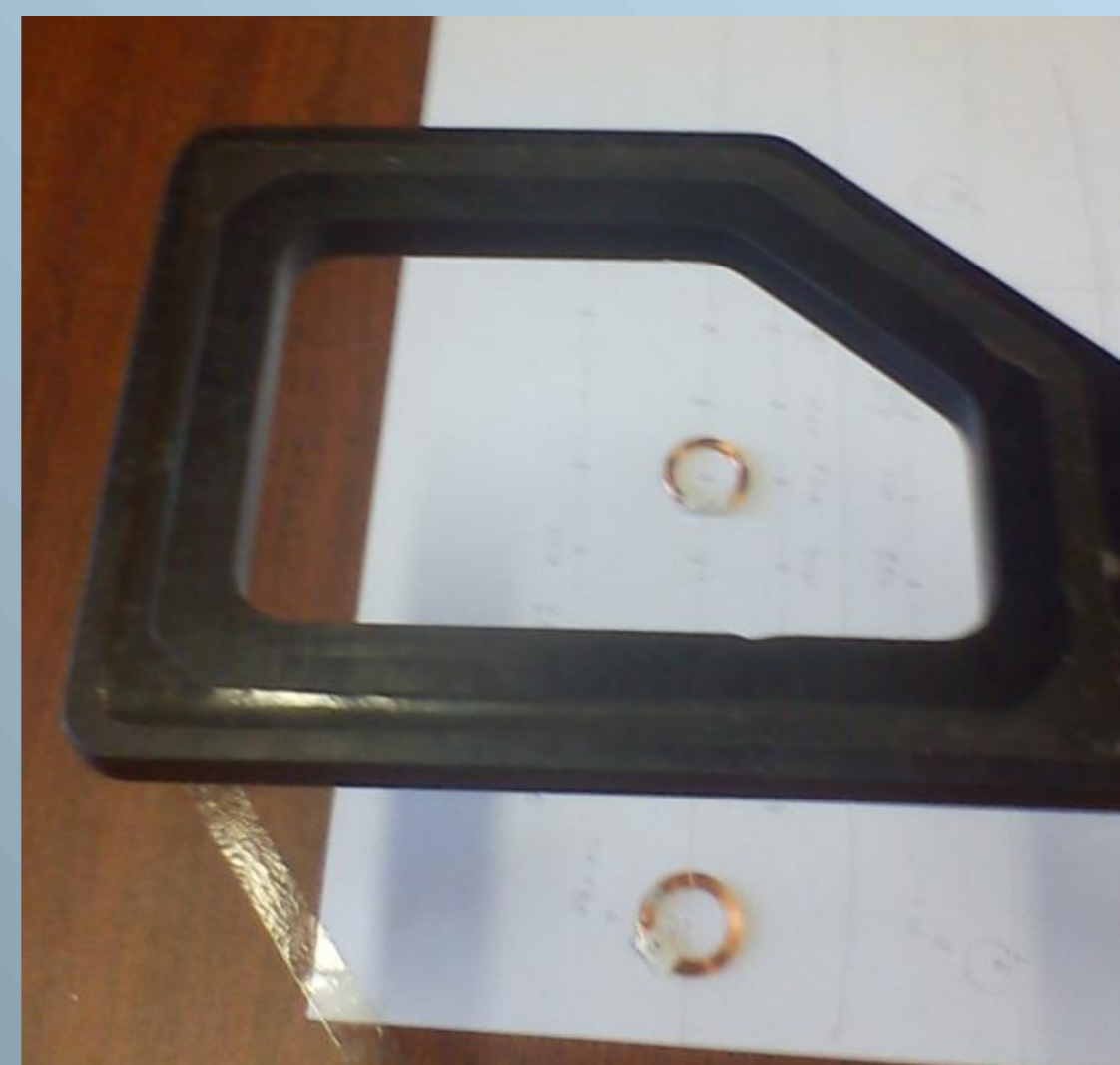
Figura 4: Montagem experimental para análise da interferência entre tags.
