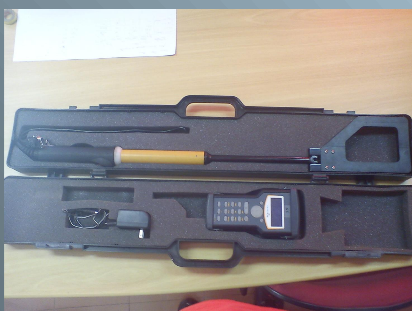
Figura 3: Antena leitora e coletor de dados.
