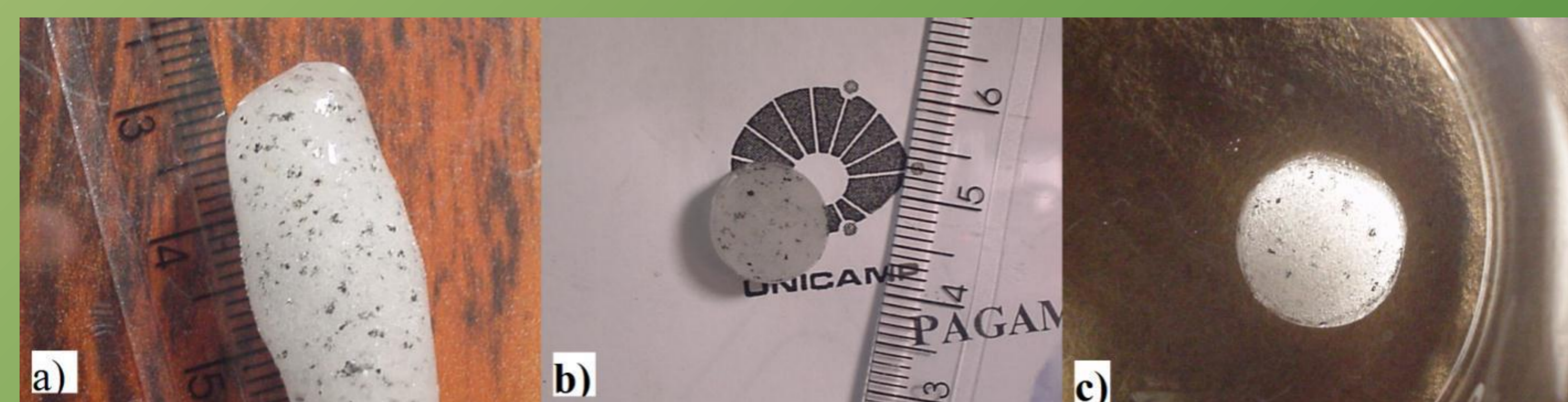
Figura 3. Silica glass obtida por fusão com quartzo de Rio Claro sem lixiviação, a) tarugo, b) secção, c) imagem por inspectoscopia óptica.
