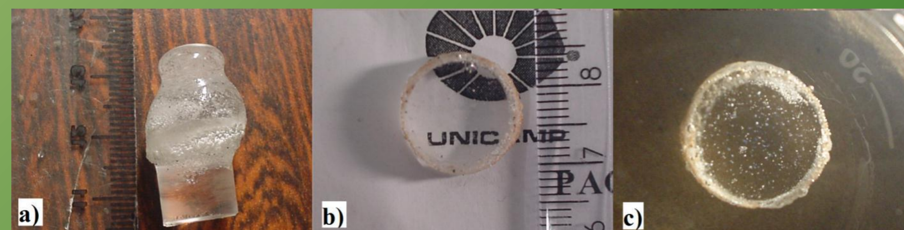
Figura 4. Silica glass obtida por fusão com quartzo de Rio Claro lixiviado, a) tarugo, b) secção, c) imagem por inspectoscopia óptica.
