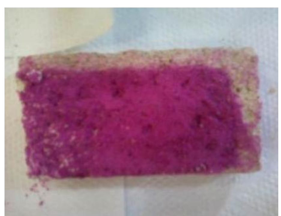
Profundidade de Carbonatação.
