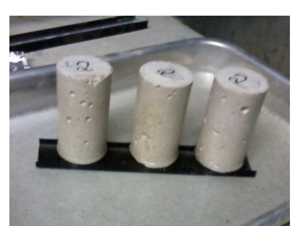
Absorção de água por capilaridade.
