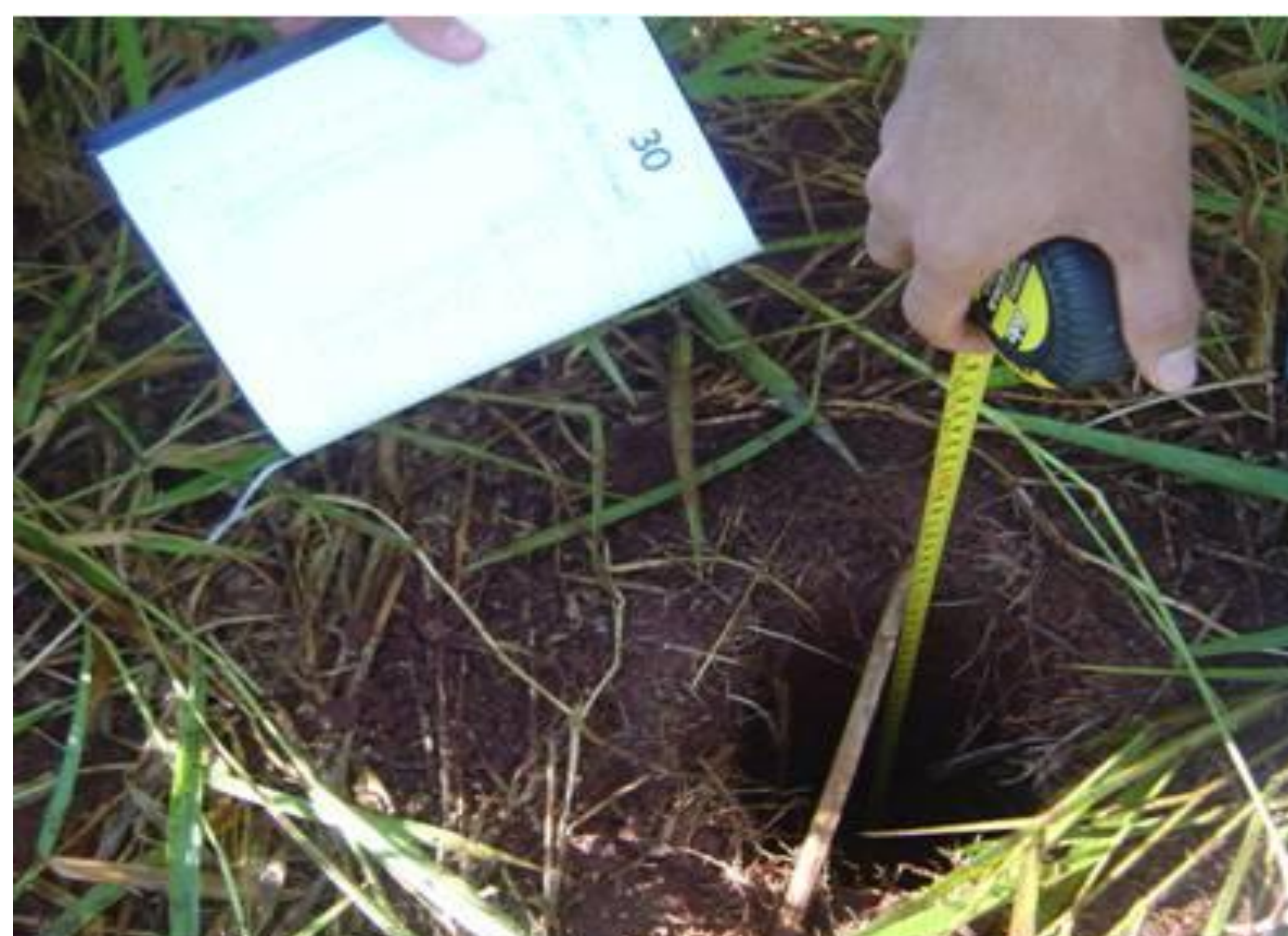
Figura 3: Poço escavado para a realização dos ensaios de infiltração de água no terreno.
