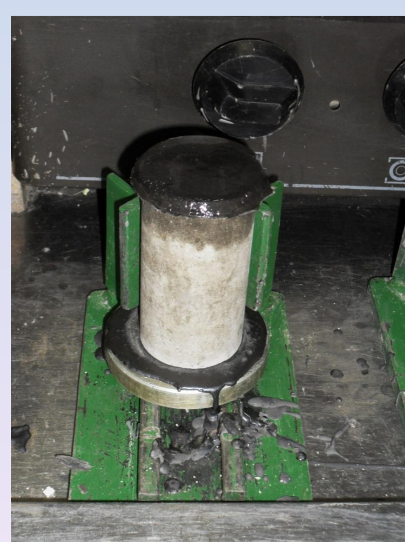
FIGURA 4 - Corpo-de-prova sendo capeado com a mistura de enxofre
