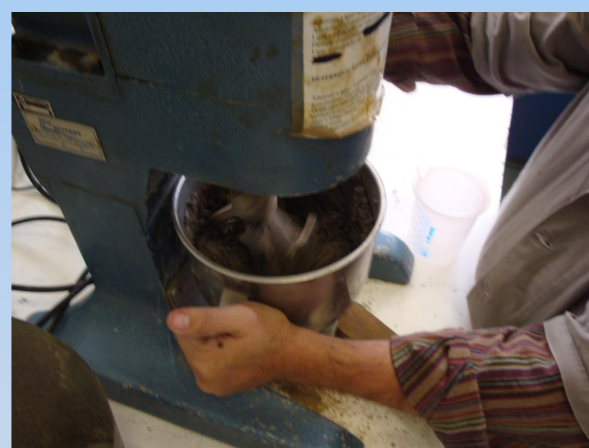
FIGURA 2 - Mistura mecânica da argamassa feita através da argamassadeira
