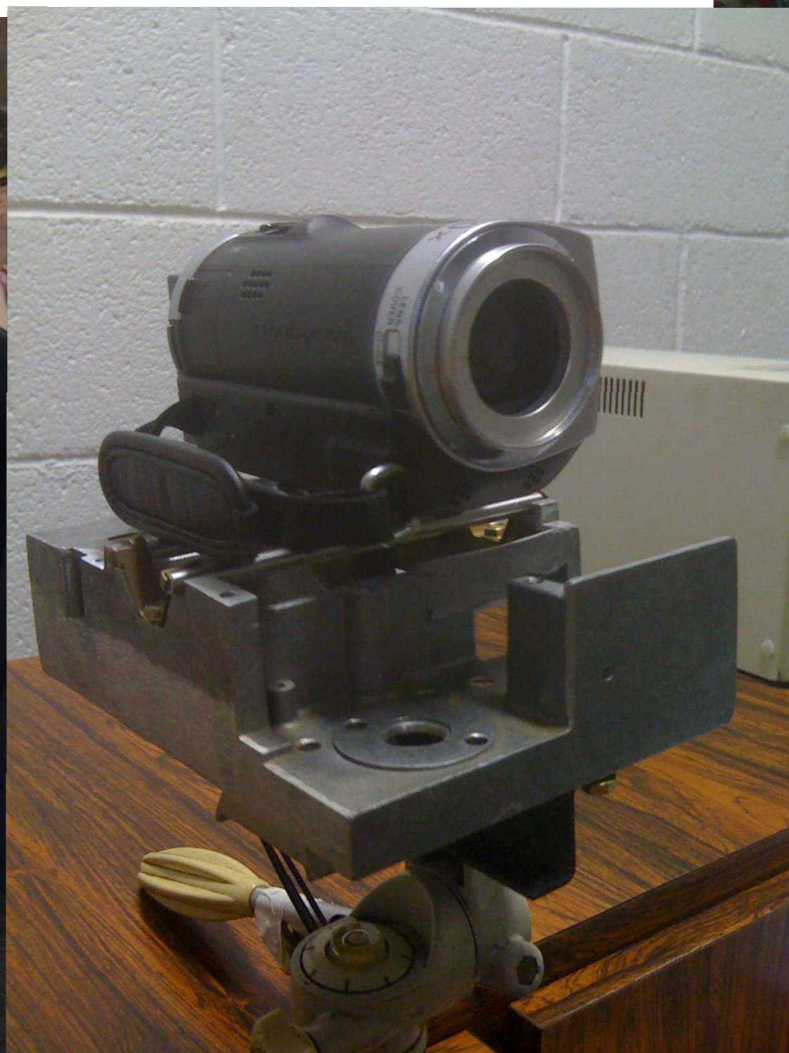
Foto 2: Suporte transladador para fazer 3D com uma câmera só.
