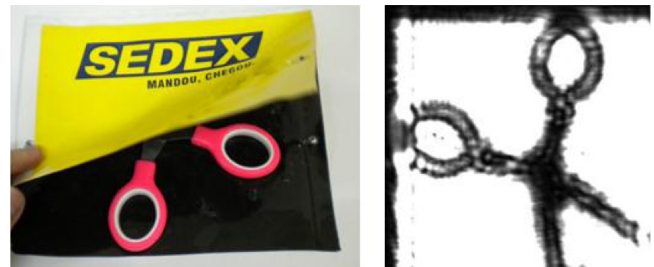
Fig. 3: Amostra de envelope plástico do correio em foto no visível e em 0.2 THz.
