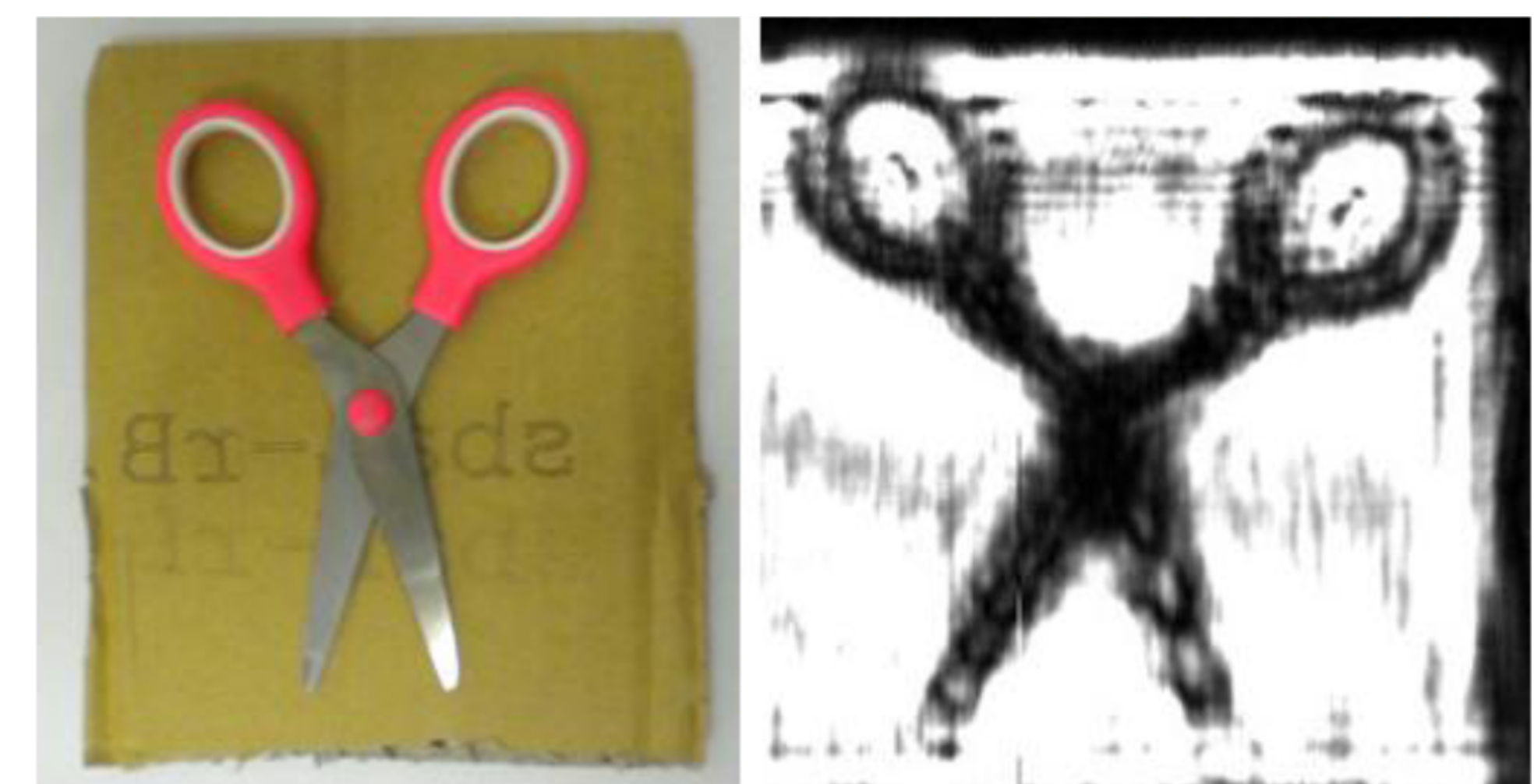
Fig. 4: Amostra de papelão em foto no visível e em 0.2 THz.
