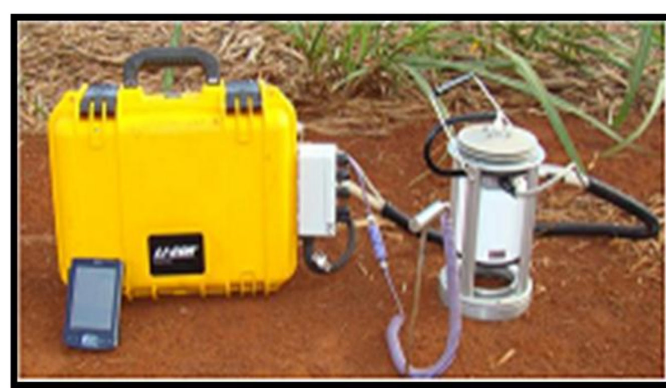
Figura 2. Sistema portátil LI-8100 com o sensor de temperatura acoplado e o palmtop.
