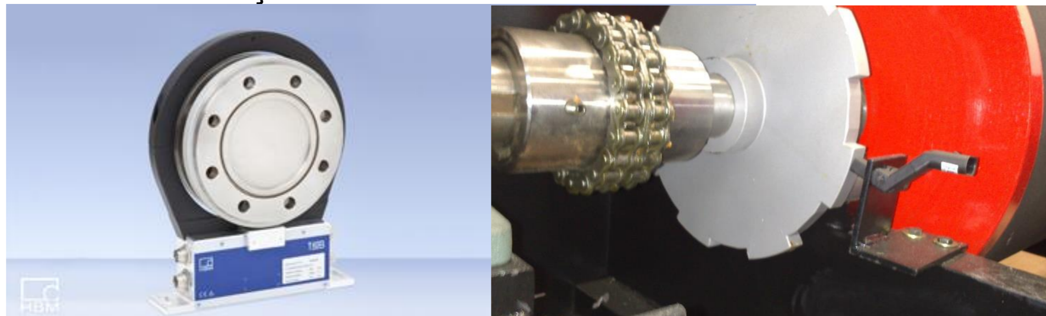
Figura 6: Torquímetro tipo flange (esquerda) e sensor de rotação indutivo à direita.
