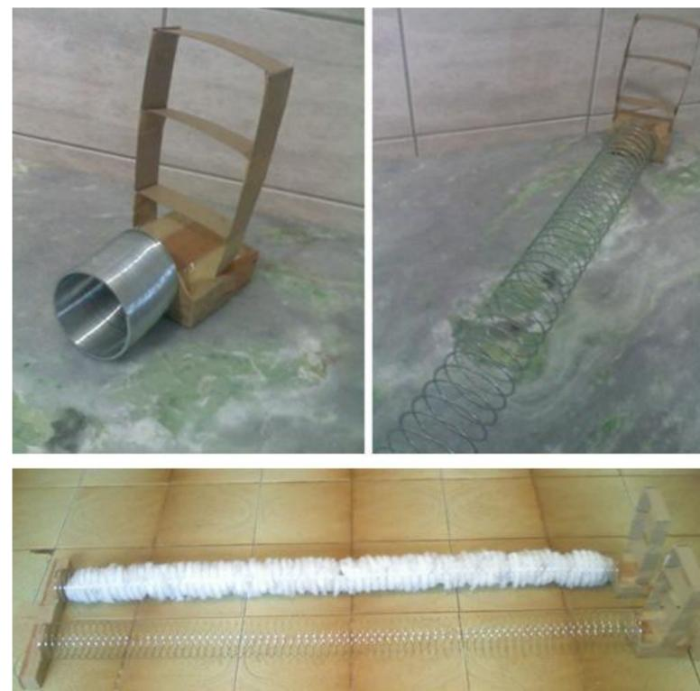
Figura 4: Produção de ondas P e S para Simulação de Terremotos
