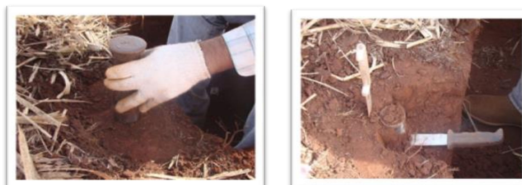
Figura 2. Coleta de amostra de solo indeformada.
