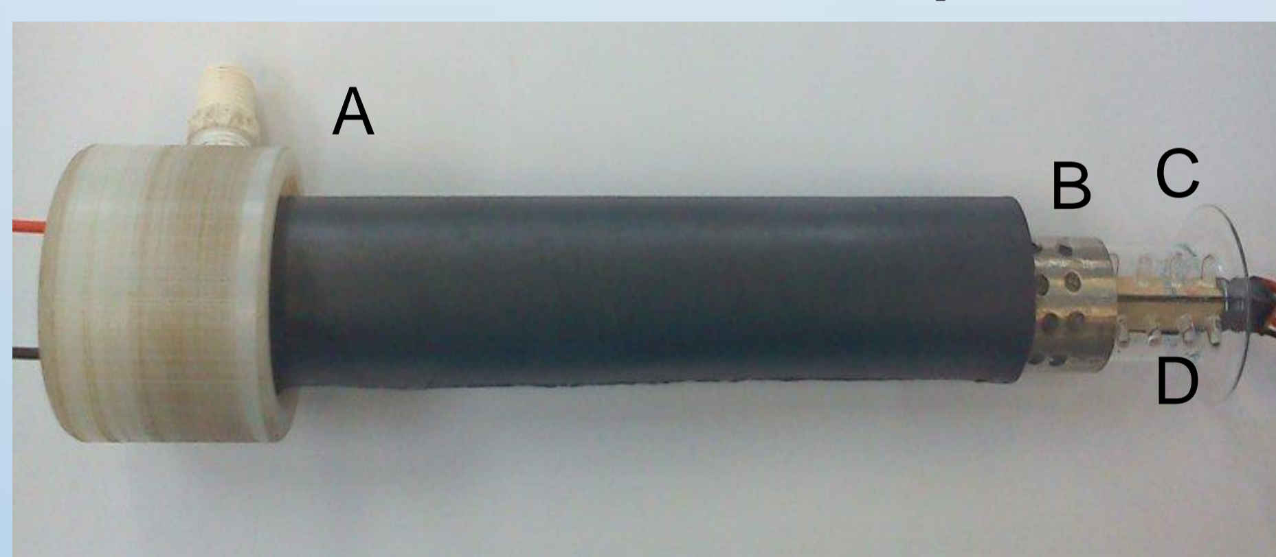
Figura 2: Foto mostrando partes internas do reator fotoeletroquímico.
