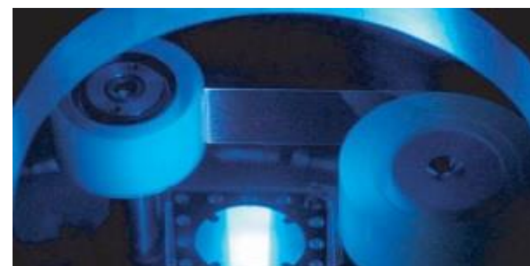
Fig. 2 – Visualização de radiação emitida ao desenrolar uma fita adesiva, através de cintiladores.
