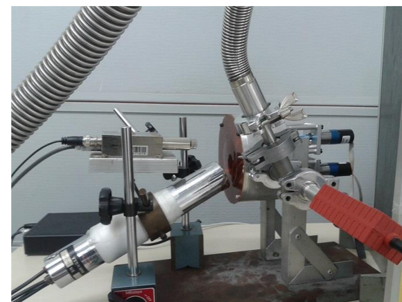
Fig. 7 – Montagem experimental para produção de raios-X ao desenrolar uma fita adesiva no vácuo.
