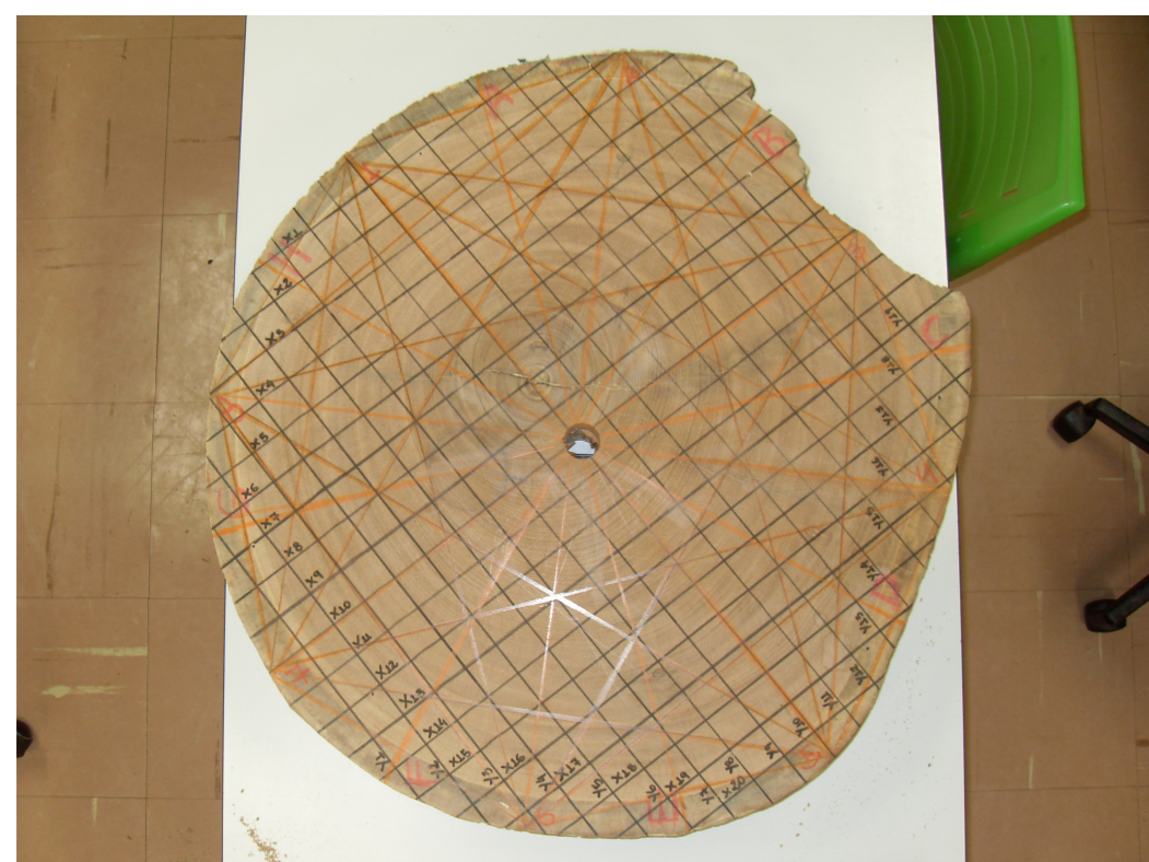
Figura 1: Foto de tora com oco de área de 10%
