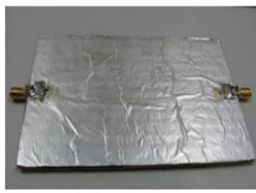
Fig. 02 – Protótipo de uma linha de transmissão construída em papelão.
