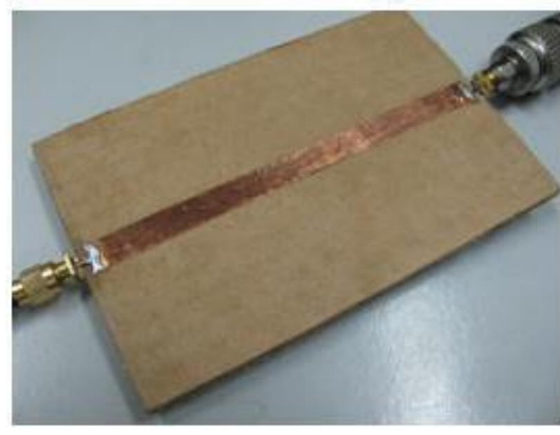
Fig. 02 – Protótipo de uma linha de transmissão construída em papelão.
