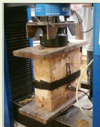
Figura 4. Máquina Universal de Ensaios (EMIC, Brasil) e ensaio de compressão dos painéis monolíticos
