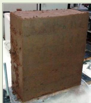
Figura 2. Parede Monolítica Moldada
