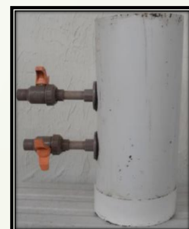
Figura 2 – Foto do reator aeróbio e esquema do reator aeróbio.
