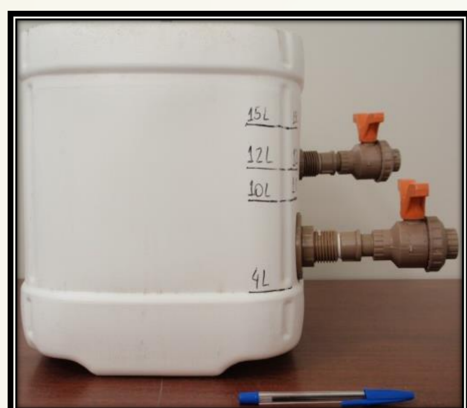
Figura 1- Foto do reator anaeróbio e esquema do reator anaeróbio.
