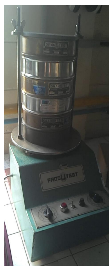
Figura 1. Peneirador mecânico, Produtest modelo "T" com as cinco peneiras
