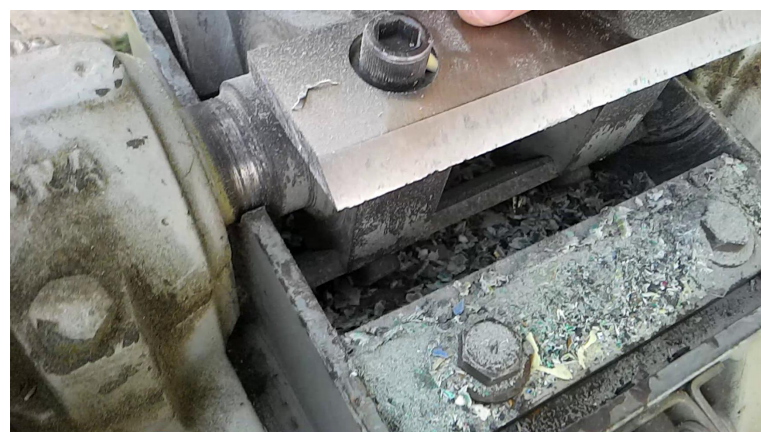
Figura 2.b Detalhe da lâmina e resíduos dentro do moinho
