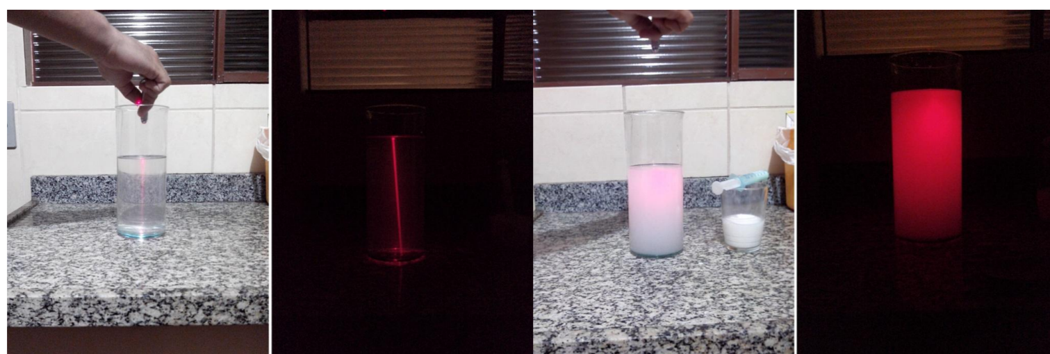
FIGURA 1: Exemplos da interação da luz com diferentes meios. O primeiro demonstra um meio "absorvedor" de luz, com uma trajetória linear (água e sal em suspensão). O segundo demonstra um meio denso, com uma trajetória "difusa" (gotas de leite - o lipídio do leite "espalha" a luz).
